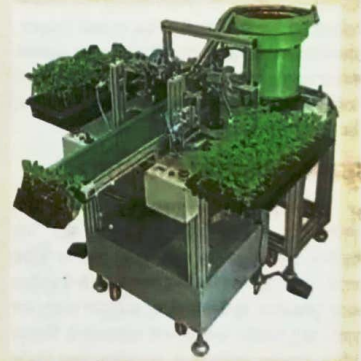
कलमीकरणाचे काम करणारा रोबोटिक प्लॅटफॉर्म.
