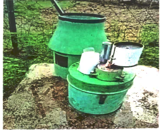
पर्जन्यमानाची सतत नोंद करणारा फ्लोट/सायफन प्रकारचा पर्जन्यमापक.
